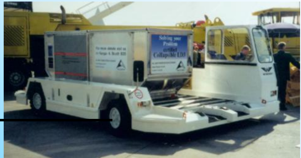
Аэродромный контейнеровоз с 300x60 гидравлическими тормозами на управляемой оси.
